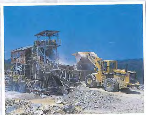
モバイルクラッシャ Mobil crushing plant
