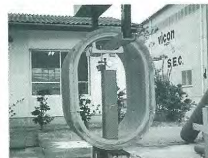
水平方向荷重試験
