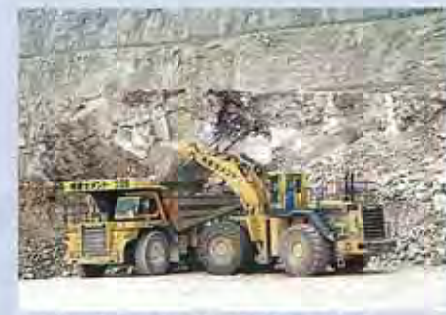
大型ダンプトラック(左)と大型ホイールローダ(右) Dump truck(L) and Front-end loader(R)
