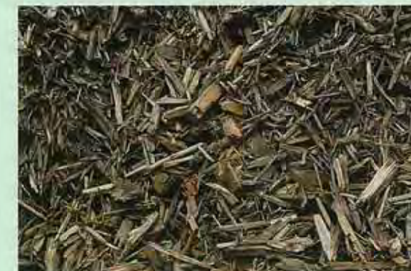
建設廃木材(チップ) Scrap wood (Chip)
