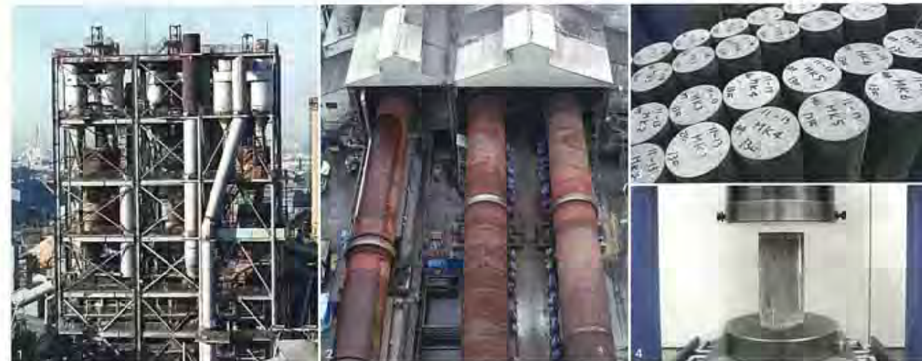
1: 原料を予熱するサスペンションプレヒーター。省エネルギー化にも貢献しています。 2: 24時間回転し続けるロータリーキルン。セメント製造の主たる工程がロータリーキルンでの焼成です。 3: 使用環境を想定して、各種セメントと骨材の配合比率を変えてつくられたコンクリート試験体。 4: 試験体の強度テスト。圧縮強度試験を繰り返し、オーダー通りの品質を追求しています。
